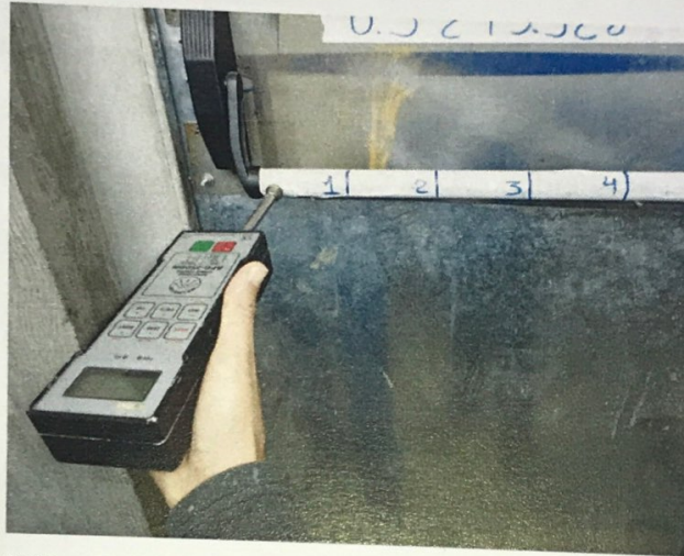
Foto n.º 01 – Ensaio de funcionamento – Lado oposto do trinco
