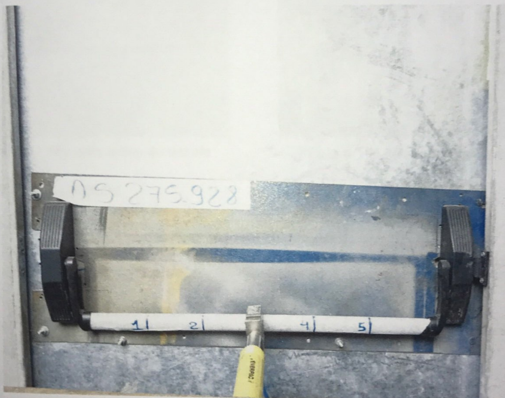
Foto n.º 06 – Ensaio de carregamento horizontal ao plano da porta
