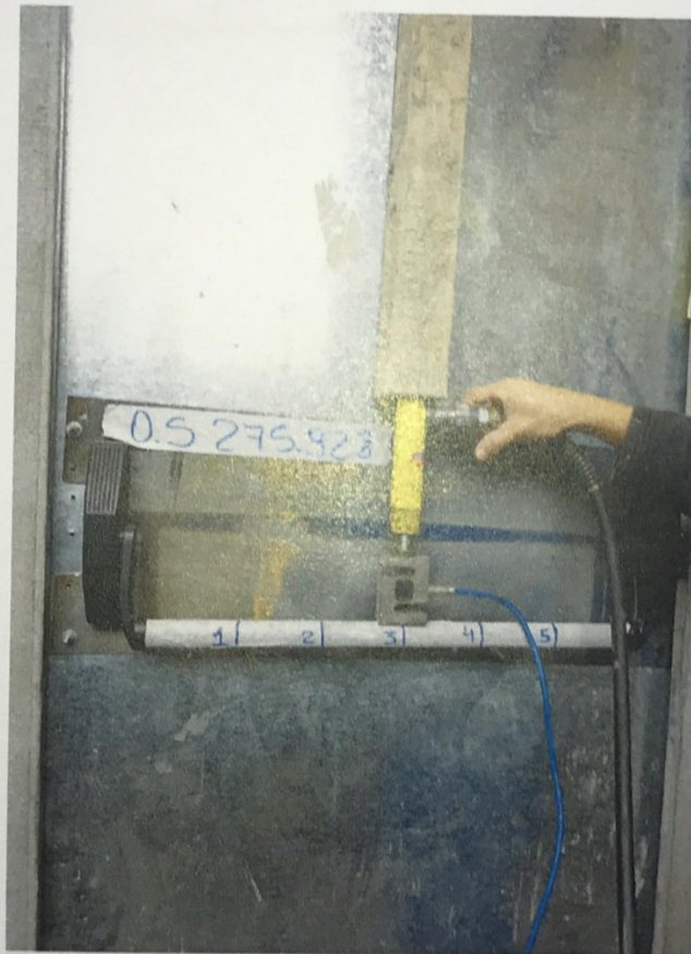
Foto n.º 05 – Ensaio de carregamento vertical
