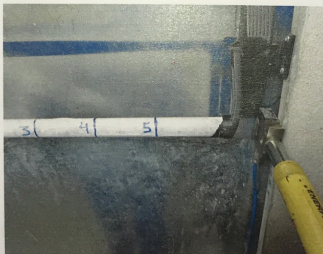
Foto n.º 04 – Ensaio de carregamento no lado oposto ao das dobradiças
